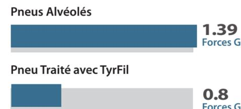
Pneus traités avec TyrFil – 41% de transmission de force G (en cabine/au chauffeur) en moins par rapport à des pneus alvéolés. Les données ont été collectées sur une chargeuse frontale testée sur une piste reproduisant des conditions de travail réelles.
