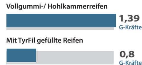
Mit TyrFil gefüllte Reifen – 41% weniger G-Kraft Übertragung auf Fahrerkabine/Fahrer als bei Vollgummi- Hohlkammerreifen. Die Daten basieren auf einem Test mit einem Frontlader unter realen Arbeitsbedingungen.
